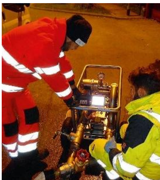
Il primo esperimento fatto a San Giuliano Milanese dove alcune zone dell'acquedotto soffrono di sedimentazione di ferro e manganese
